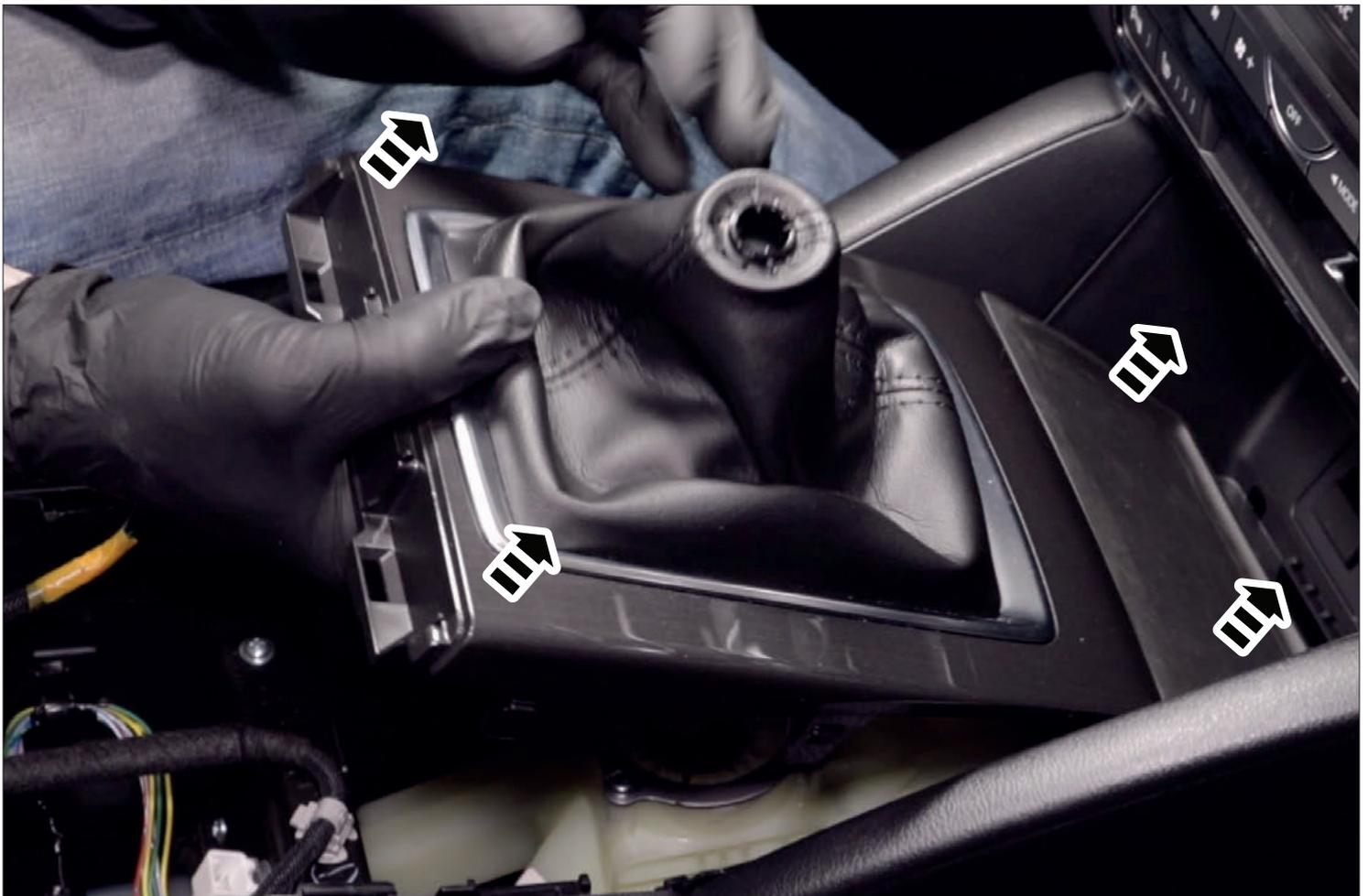
Bitte entfernen Sie die OEM Matte, welche auf der Unterseite durch Clipse gehalten wird, wie in den folgenden Schritten beschrieben.
