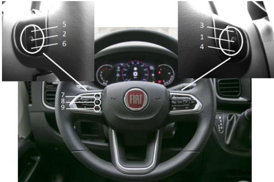
Die Lenkradtasten 1-6 sind auf der Rückseite des Lenkrades angeordnet und haben die folgenden Funktionen (sofern vom Radio unterstützt):
