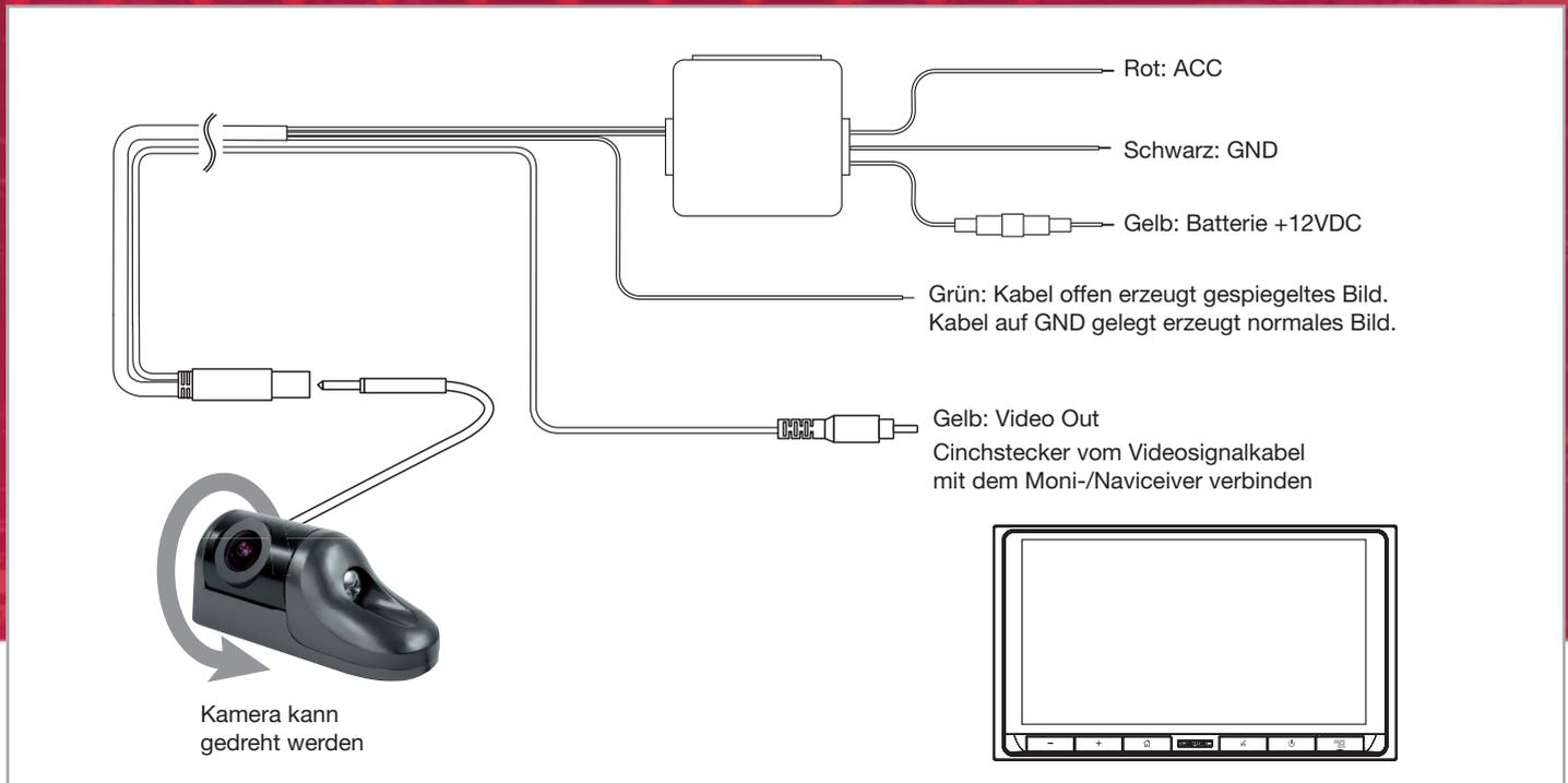
Die ZE-RVC80MT MKII eignet sich durch ihre kompakte Bauform auch zur Montage am Nummernschildhalter, oder unterhalb des Stoßfängers, je nach Fahrzeugmodell und gewünschtem Resultat. Das von der Kamera wegführende Verbindungskabel kann sehr oft durch die Zuführung der Nummernschildbeleuchtung gelegt werden. Auch bietet der hochwertige CMOS-Sensor einen temperaturmässig erweiterten Einsatzbereich, sowie ein wasserdichtes (IP68) Gehäuse aus eloxiertem Aluminium-Druckguß.
